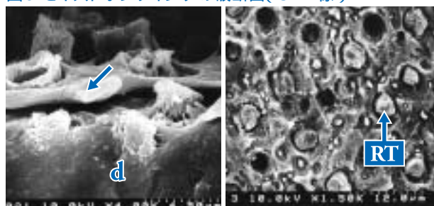
図3. モイストボンディングの破断面(SEM像)
